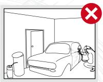
Não. Porquê? A pintura é efectuada fora de uma câmara de pulverização. A postura do trabalhador não é adequada.
