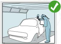
**Sim. Porquê?** É utilizada uma câmara de pulverização e o trabalhador tem equipamento de protecção individual completo.
