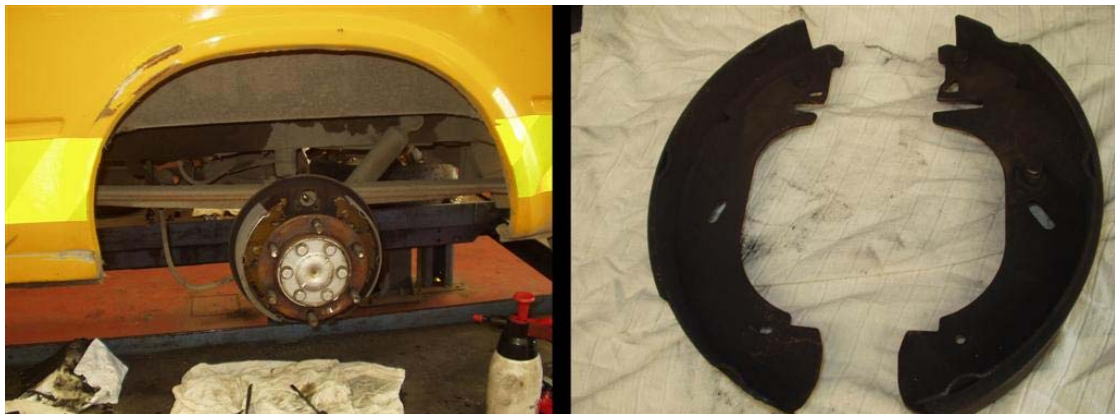
Figura 18.1 Amianto nas pastilhas dos travões de um camião.
