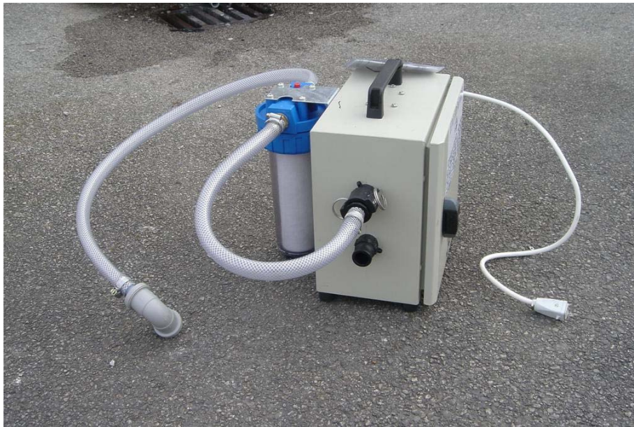
Figura 8.1 Filtro de água para as águas residuais da unidade de descontaminação. Fotografia cedida pelo HSE do Reino Unido.
